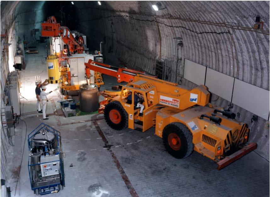
Abbildung 4.8: Erprobung eines Einlagerungssystems für hochradioaktive Abfälle [27]
