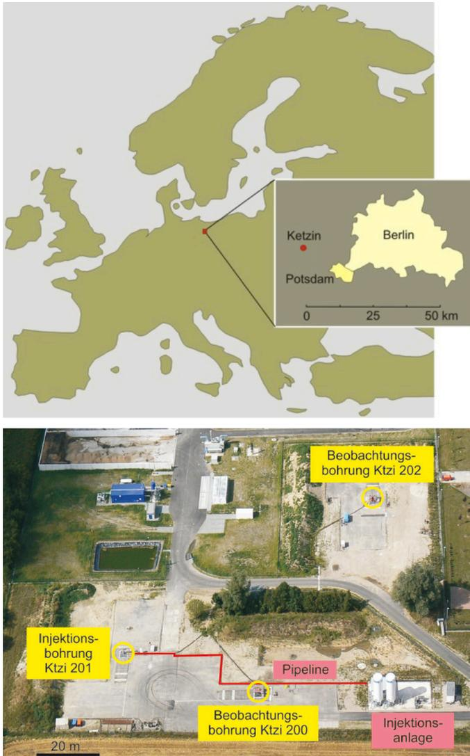
Abbildung 5.5: Pilotstandort zur geologischen CO<sub>2</sub>-Speicherung im Havel-ländischen Ketzin bei Berlin und Potsdam (oben). Luftbild des Standortes mit Injektionsanlage und Bohrungen.
