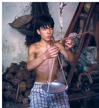
Nun folgt der zweite Schritt ( 第二步 ), die Eichung der Skalen. Diese wird empirisch vorgenommen. Dazu werden verschiedene Standardgewichte aufgelegt und das Laufgewicht so verschoben, daß die Waage ausbalanciert ist. Die Position des Laufgewichtes wird sodann markiert. Für jedes der beiden Fulcra werden jeweils zwei Punkte auf der Skala markiert. Hier im Bild wird der Null-
