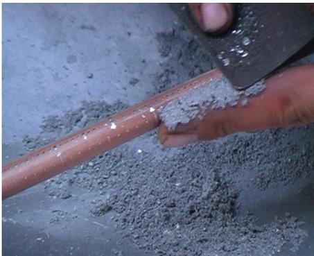
In diese Bohrlöcher wird dann ein Pulver, das aus Quecksilber und Zinn im Mischungsverhältnis 1:2 besteht, eingerieben (links). Die so entstehenden silbrigen Markierungen auf der Skala werden „Sterne“ genannt.
