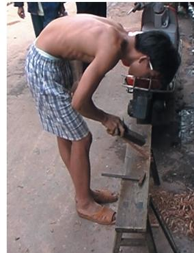
Ein unbearbeiteter Holzbalken wird auf eine Länge von 1,8 chi 尺 (60 cm) zurechtgesägt und gehobelt (Bild oben rechts).
