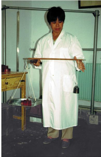
Zur empirischen Bestimmung der Lage des Fulcrums wird also der Auflagepunkt variiert, während Lastgewicht und Gegengewicht (das Laufgewicht am Ende des Balkens) vorgegeben sind. Hier wird also das gleiche Verfahren verwendet, das dem Besmer, der Waage mit beweglichem Fulcrum, zugrundeliegt.
