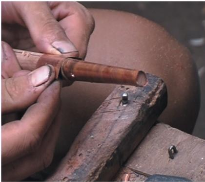
Dann werden die Enden des Balkens zugeschliffen und die Metallkappen aus Kupferblech angebracht.
