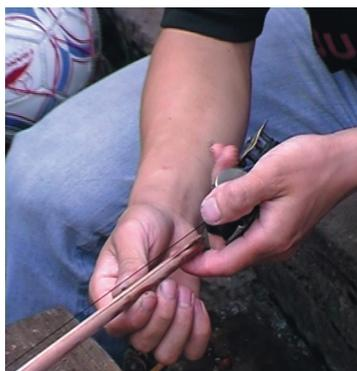
Anschließend wird der Balken feinbearbeitet (feilen, schmirgeln etc.). An beiden Enden des Balkens werden dann Markierungen eingeritzt, die die Größe der später anzubringenden Metallkappen vorgeben.
